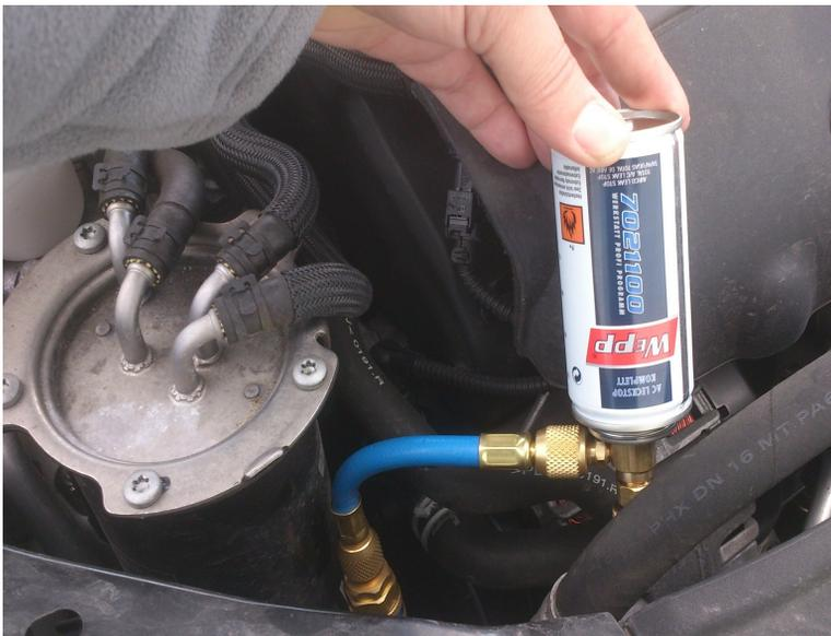
mit dem Niederdruckanschluß der Klimaanlage sicher verbinden. Dann die Ventilöffnungsschraube in das Dosenventil eindrehen. Die Dose daraufhin möglichst mit dem Ventil nach unten halten.
